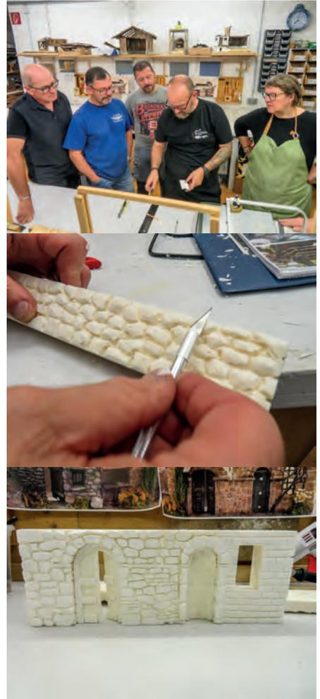
Sah einfach aus - wenn das Klebeband nicht verrutscht, der Schnitt plötzlich eine andere Richtung nimmt und der Heißdraht eine breite Stelle schmilzt, weil man ratlos innehält und die Stromzufuhr für den Draht nicht unterbricht. Na ja, auch hier gilt: Übung macht den Meister! Also nicht aufgeben!
